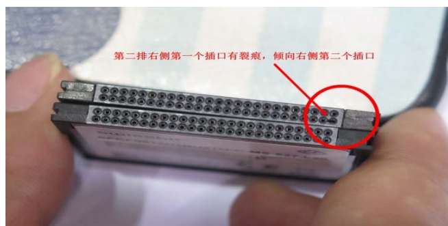
图2 A套PCC故障使用的CF卡与新CF卡对比图
