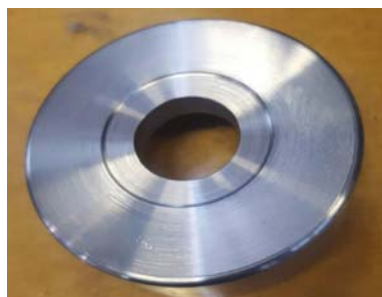
图8 ESV阀内部气囊弹簧底座
